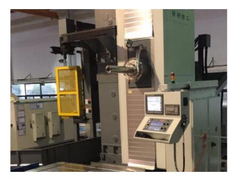
数控机床的切削加工是由刀具与工件之间的相对运动来实现的,其运动可分为表面形成运动和辅助运动两类。表面形成运动是使工件获得所要求的表面形状和尺寸的运动,它包括主运动、进给运动和切入运动。主运动是从工件毛坯上剥离多余材料时起主要作用的运动,它可以是工件的旋转运动(如车削)、直线运动(如在龙门刨床上刨削),也可以是刀具的旋转运动(如铣削和钻削)或直线运动(如插削和拉削);进给运动是刀具和工件待加工部分相向移动,使切削得以继续进行的运动,如车削外圆时刀架溜板沿数控机床导轨的移动等;切入运动是使刀具切入工件表面一定深度的运动,其作用是在每一切削行程中从工件表面切去一定厚度的材料,如车削外圆时小刀架的横向切入运动。辅助运动主要包括刀具或工件的快速趋近和退出、数控机床部件位置的调整、工件分度、刀架转位、送夹料,启动、变速、换向、停止和自动换刀等运动。数控机床:数控机床是数字控制机床的简称。重型数控机床厂家直销
