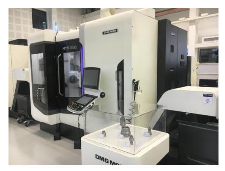
数控机床加工原理: 1、机床本体数控机床的机床本体与传统机床相似,由主轴传动装置、进给传动装置、床身、工作台以及辅助运动装置、液压气动系统、润滑系统、冷却装置等组成□2□CNC单元CNC单元是数控机床的关键□CNC单元由信息的输入、处理和输出三个部分组成。 3、输入/输出设备输入装置将各种加工信息传递于计算机的外部设备。4、伺服单元伺服单元由驱动器、驱动电机组成,并与机床上的执行部件和机械传动部件组成数控机床的进给系统。重型数控机床厂家直销数控机床相比较于传统的设备具有较为突出的性能优势。
